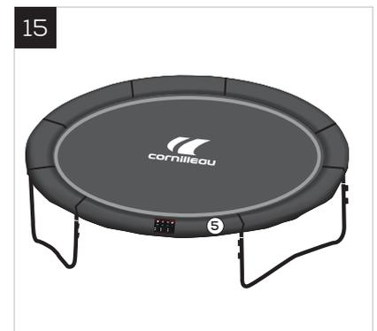
Ajustez le coussin de sécurité sur le maillage élastique avec les rabats relevés. Assurez-vous que chaque couture soit alignée en face d'un connecteur de tube en T et que les consignes de sécurité soient bien situées face à l'entrée du filet de sécurité.
