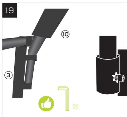
Insérez l'extrémité inférieure des poteaux d'enceinte de sécurité dans les tubes du connecteur T et du pied W. Puis fixez les à l'aide des vis en utilisant la clé 6 pans.
